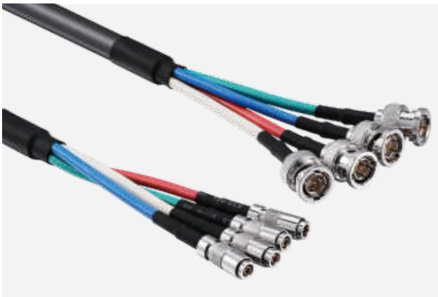
CoaXPress 是一种非对称的高速串行通信数字标准。该标准容许设备（如：数字相机）通过单根同轴电缆连接到主机（如：个人电脑中的数据采集设备），以高达 6.25 G比特/秒的速度传输数据。鉴于 CoaXPress 具备多通道传输图像数据和元数据的能力，因此，设备可以不必是单独的一部摄像机，也可以是一种将数字摄像机之间的数据连接到一起的接口设备。
