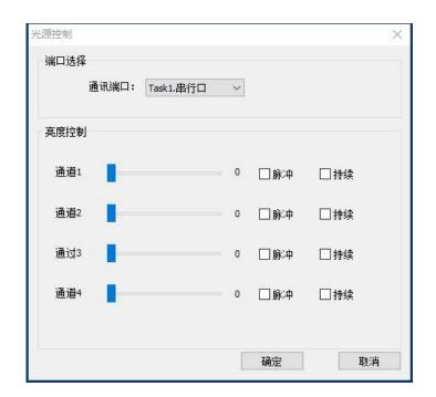
**CK 光源控制工具使用方法:** (使用工具控制时无需过多操作本机,接好串口线,打开电源开关即可)
